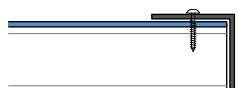
Winkel aus Stahl oder Alu. Die Winkel können geklemmt oder geschraubt werden.
